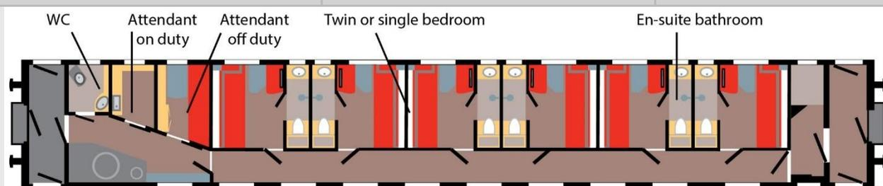
El vagón es de 6 compartimentos, 2 camas en cada uno, arriba y abajo. Una mesa y un sillón. Un equipo de LCD TV. Un armario para guardar ropa. Un baño ecológico propio del compartimento con la ducha a ras de suelo y lavabo. Aire acondicionado propio del compartimento frío/calor.
