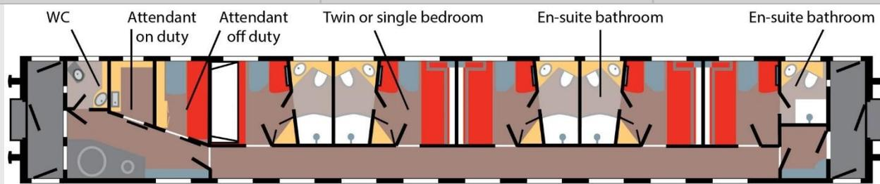
El vagón es de 5 compartimentos, 2 camas en cada uno, de arriba y de abajo. Una mesa y un sillón. Un equipo de LCD TV. Un armario para guardar ropa. Un baño ecológico propio del compartimento con ducha (cabina) y lavabo. Aire acondicionado propio del compartimento frío/calor.
