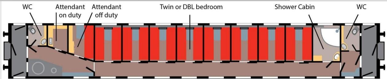
El vagón es de 8 compartimentos, 2 camas abajo. Una mesa. Un equipo de LCD TV. Un espacio para guardar ropa. En el compartimento número 9 está la ducha (cabina) con el lavabo. 2 baños ecológicos al principio y al final del vagón. Aire acondicionado general para todo el vagón con la posibilidad de regularlo  $\pm 3$  CO desde cada compartimento.
