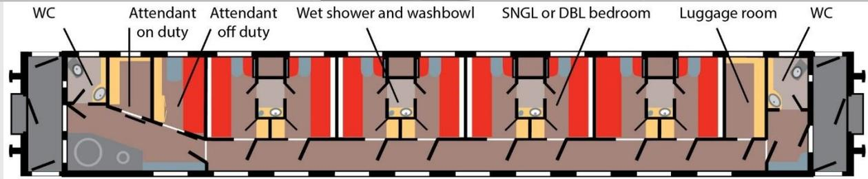
El vagón es de 8 compartimentos, 2 camas en cada uno, arriba y abajo. Una mesa y un sillón. Un equipo de LCD TV. Un armario para guardar ropa. La ducha a ras de suelo y el lavabo compartidos entre 2 compartimentos con acceso propio. En el compartimento número 9 se guarda el equipaje. 2 baños ecológicos al principio y al final del vagón. Aire acondicionado general para todo el vagón con la posibilidad de regularlo  $\pm 3$  CO desde cada compartimento.
